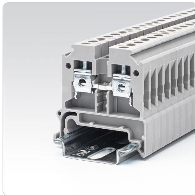
ترمینال ریلی یک طبقه شرکت رعد، سیم گیری به صورت پیچی با سطح مقطع 4 میلی متر و جریان نامی 32 آمپر
